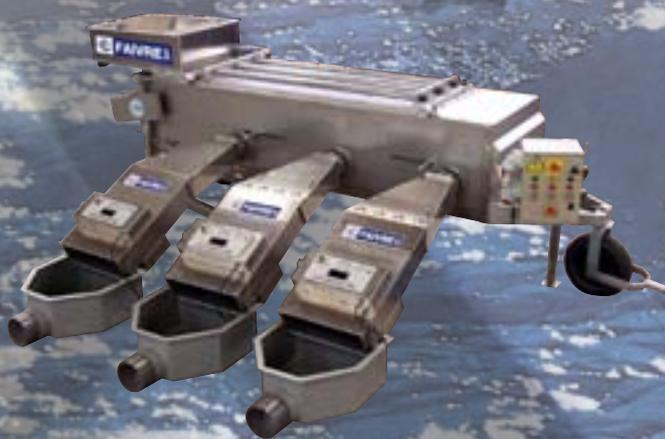
Sortiermaschine Helios 30 mit 3 Fischzählern
