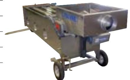
*Die Messungen erfolgten mit einem Höhenförderer und einer Pumpe, die einen konstanten und gleichmäßigen Fischdurchsatz erlauben.*
