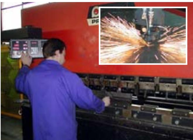
Blechverformungsmaschine mit numerischer Steuerung. Laser für den Zuschnitt komplizierter Formen aus Edelstahl.
